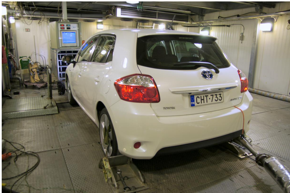
Kuva 3. Henkilöauto alustadynamometrillä VTT:n ajoneuvolaboratoriossa.
