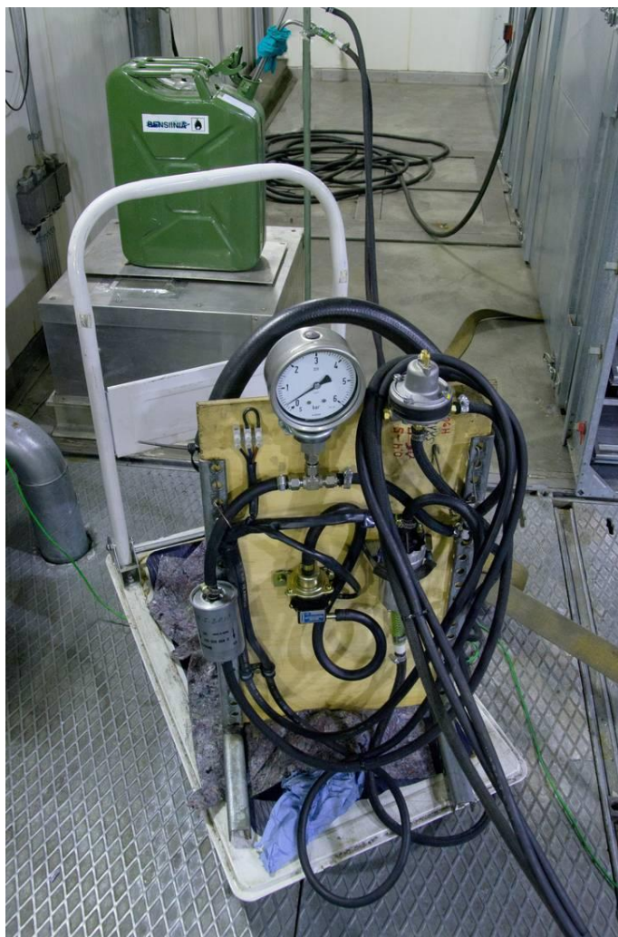
Kuva 1. Kokeissa käytetty polttoaineen siirtopumppu ja paineensäätimet, ja taustalla koepolttoainetta sisältävä astia vaa'alla.
